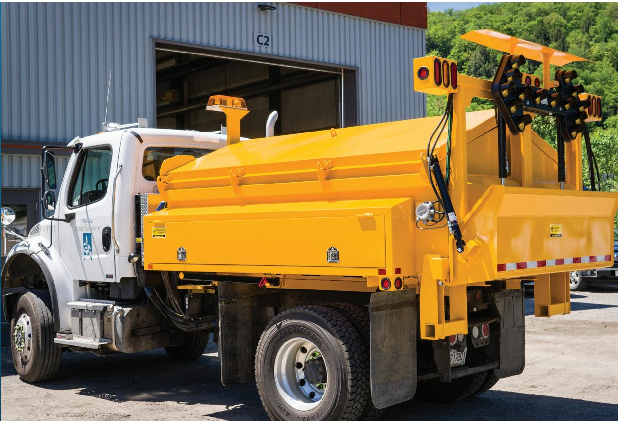
La benne à asphalte isolée **MF** permet de garder l'asphalte au chaud pendant plusieurs heures. Elle a été conçue pour l'adaptation facile au système de transfert d'équipement MF et est disponible en différents formats selon vos besoins.
